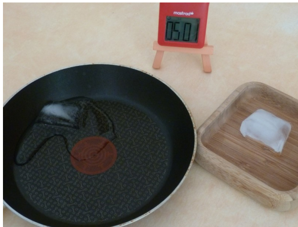
FIGURE 1 – Deux glaçons identiques sur une poêle et un récipient en bambou, 5 minutes après qu'ils ont été posés sur leur support respectif. D.R.
