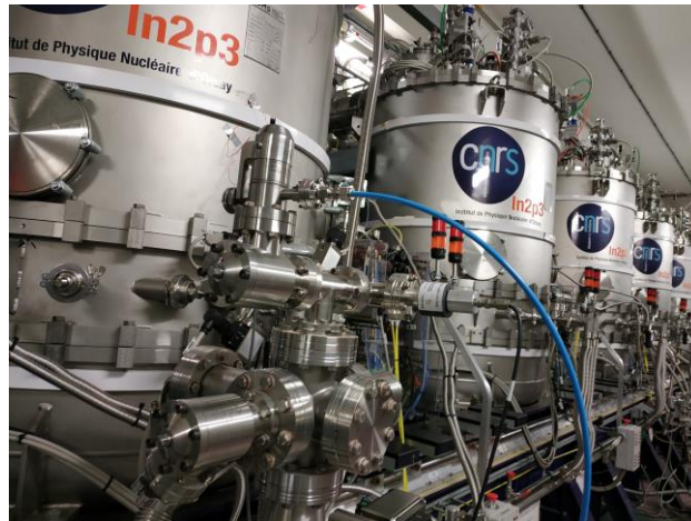
Série d'enceintes cryogéniques contenant les cavités de l'accélérateur linéaire SPIRAL 2
